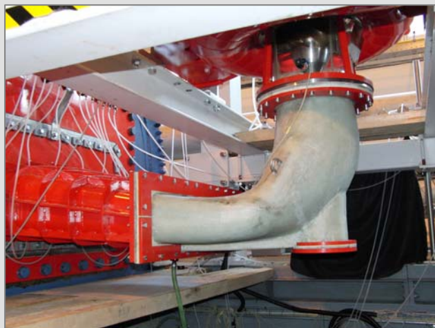
Měření na modelu Kaplanovy turbíny VE Slapy
